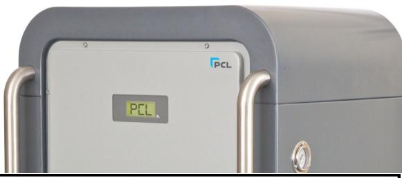
**NOTA:** O mostrador exibe SOMENTE a pressão interna do TANQUE de nitrogênio, NÃO a pressão no pneu sendo enchido. Isso é feito pelo dispositivo portátil usado com o aparelho. A tela continuará a piscar entre a leitura de pressão (em tempo real) no tanque e "n2". A leitura de pressão deve aumentar com a pressão real até atingir 116 psi (8 bar). O mostrador, no entanto, permanecerá ligado e piscando continuamente entre n2 e a pressão no tanque ao terminar.
