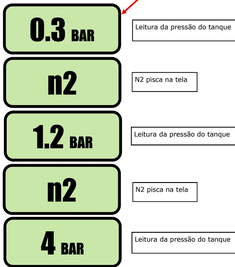
A leitura final mostrará a pressão máxima do tanque de 116 PSI (8 bar) e, em seguida, piscará "n2" continuamente. Lembre-se de que, na versão N6, a pressão máxima do tanque é de 145 psi/10 bar.
