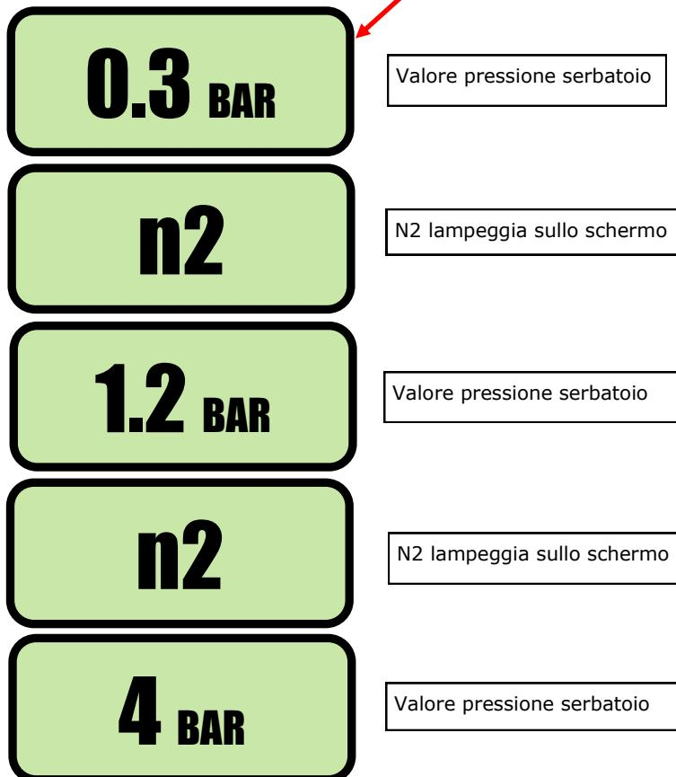
Il valore finale mostrerà la pressione massima del serbatoio 116PSI (8bar), poi lampeggerà 'n2' in modo continuo.
